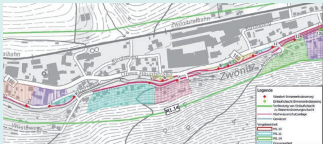
Dafür sind in der Ortslage Burkhardtsdorf entlang der Hochwasserschutzbauwerke am Fließgewässer Zwönitz 49 Saugstellen errichtet worden, an diese die sich im Zentrallager Binnenentwässerung befindlichen Pumpen, welche mittels Notstromaggregat betrieben werden, eingelassen und die Wassermengen, welche bei einem anhaltenden Regenereignis im Binnenland anfallen, in das Fließgewässer Zwönitz abgepumpt werden.
